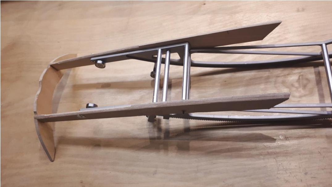
*Grafik 1.10.2 Längs- und Querspant zur Befestigung des ORBIS an der Rumpfoberseite*
